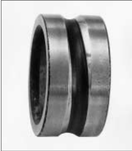
39: Huella de rodadura oblicua del aro interior de un rodamiento rígido de bolas
