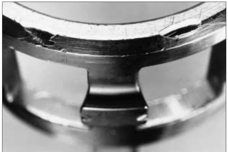
95: Jaula metálica con marcas de golpes
