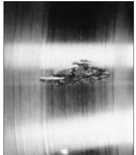
52: Mecanismo de fallo como en la figura 51, pero en este caso el desgaste se produce junto a los bordes del camino de rodadura, en cuanto al registro de forma transversal del rodillo, véase figura 69.
