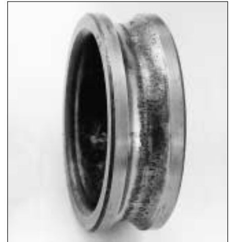
42: Deterioro avanzado por fatiga en un rodamiento rígido de bolas
