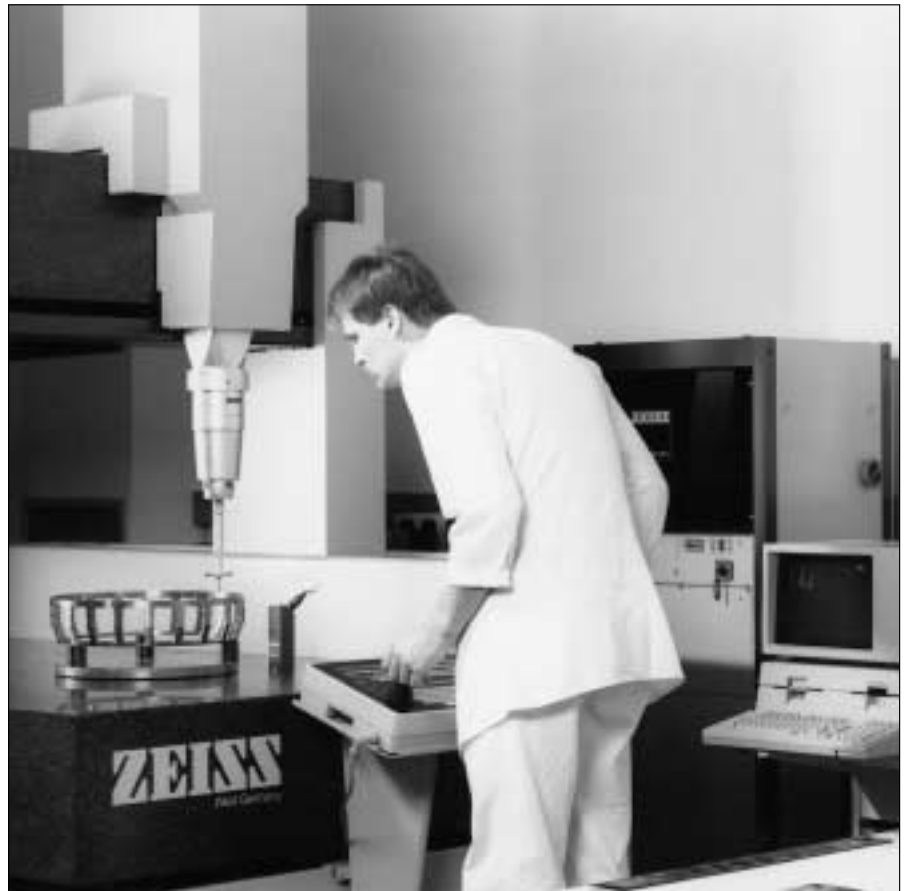
105: Máquina de medición de coordenadas
