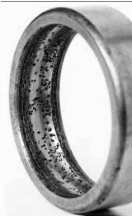
53: Oxidación en el aro exterior de un rodamiento rígido de bolas cuya protección contra la corrosión ha sido destruida por la humedad
