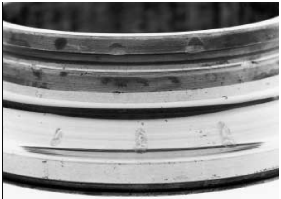
57: Falso brinelling en un rodamiento de bolas
