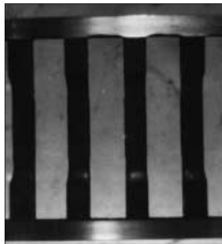
88: Desgaste en los márgenes laterales
