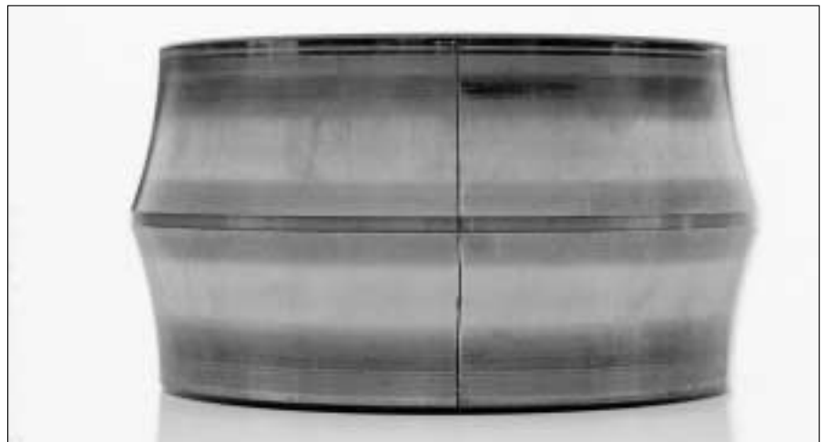
64: Rotura axial del aro interior de un rodamiento oscilante de rodillos
