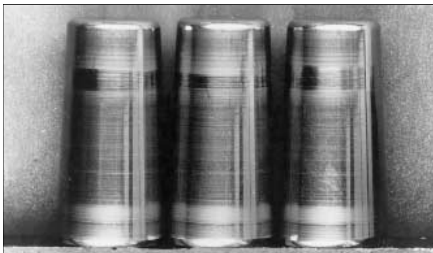
67: Las huellas de desgaste se suelen poder reconocer en primer lugar en las superficies de los cuerpos rodantes.
