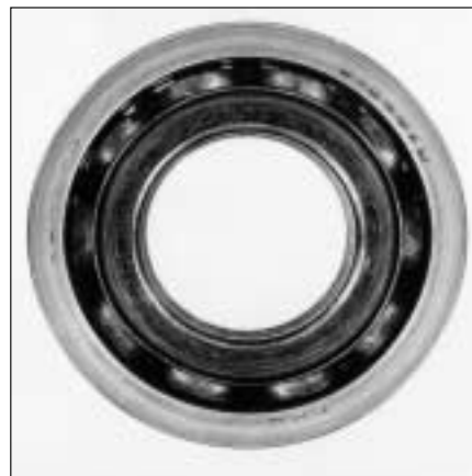
17: Estrías circunferenciales y soldaduras en frío en la superficie frontal del aro interior como consecuencia del giro relativo del aro interior sobre el eje
