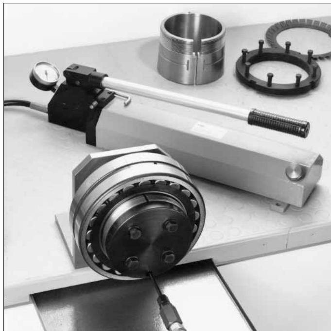
56: Montaje de un rodamiento oscilante de rodillos con agujero cónico, mediante el sistema hidráulico.
